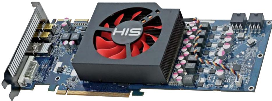
Le PCB de la Radeon HD7950 a été revue pour réduire les coûts. Il en va de même pour le ventirad qui devient totalement sous-dimensionné.
