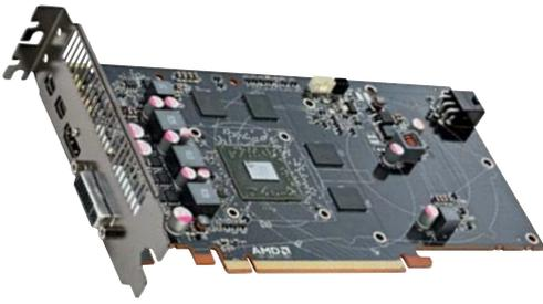
Les PCB des Radeon HD7770 et 7750 sont relativement simples puisque les GPU sont très économes. La HD7770 ne peut toutefois pas encore se passer de connecteur PCI-Express 6pins.
