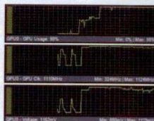
Palit GF GTX 650 Ti Boost 的實際 Boost 時脈達到 1,124MHz，遠高於其他受測型號。
